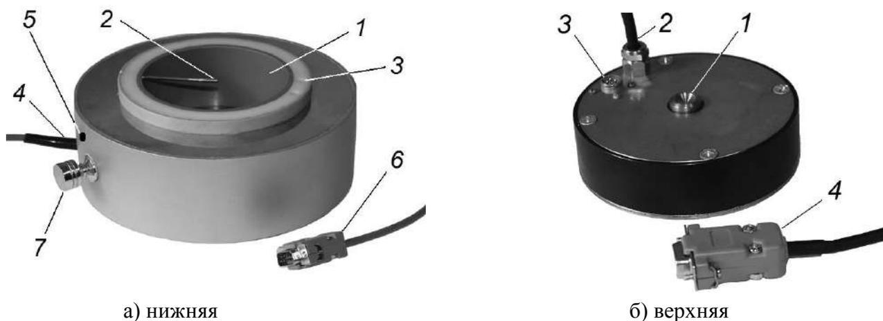
Рисунок 1.4 – Термостатированные плиты
