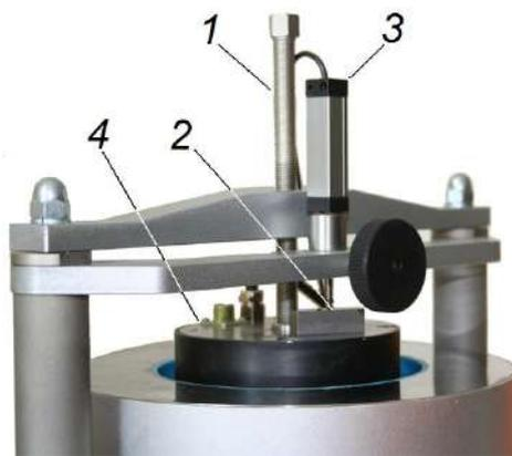
1 – винт нагружения; 2 – мера длины концевая плоскопараллельная (КМД);
